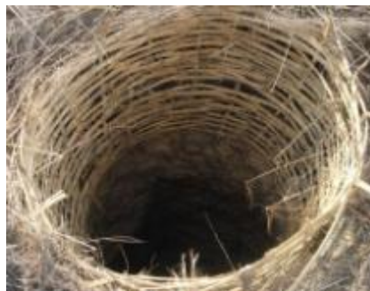
Essais de stabilisation des fosses avec des nasses en osier : ne permet pas un gain en durabilité significatif
