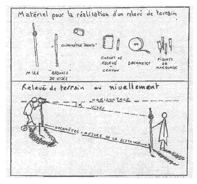
Pour faire les mesures de nivellement, on a besoin d'une mire ; il s'agira dans notre cas d'un bâton (ou d'un tuyau) sur lequel on aura marqué un repère distinct à hauteur de l'œil de la personne qui mesure.
